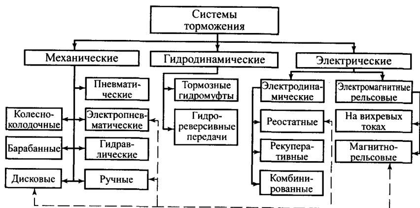
Рис. 4.1. Классификация систем торможения подвижного состава
